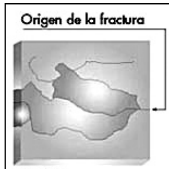
Fig. 7.6: fractura por stress térmico de alta tensión (gentileza VASA)
