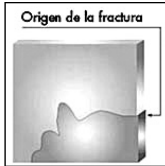
Fig. 7.5: fractura por stress térmico de baja tensión (gentileza VASA)
