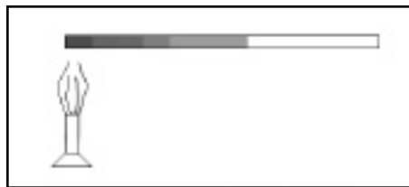
Fig. 4.1: transmisión de calor por conducción.
