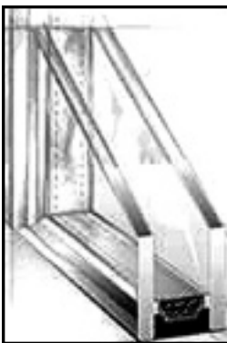
Por medio de un separador metálico (normalmente aluminio). Fig 3.8
