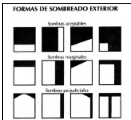
Fig. 7.3: sombras exteriores y su influencia en el stress térmico (fuente: BI 13 VASA)
