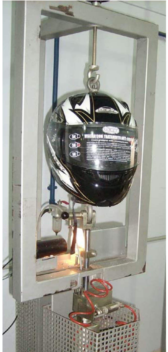
3. Ensayo realizado sobre la cinta de ajuste de los cascos.
