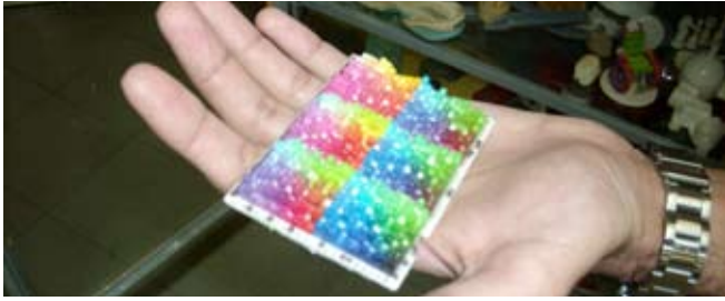
2. Muestrario de colores con los que se pueden producir prototipos rápidos a partir de de las impresoras tridimensionales.
