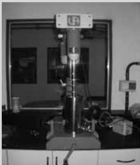
Dispensora de alta velocidad con molino de perlas adosado al equipo.
