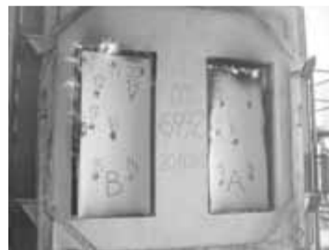
Ensayo de resistencia al fuego de puertas
