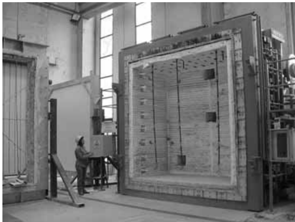
Equipo para la simulación de incendios para ensayos a escala real de elementos constructivos
