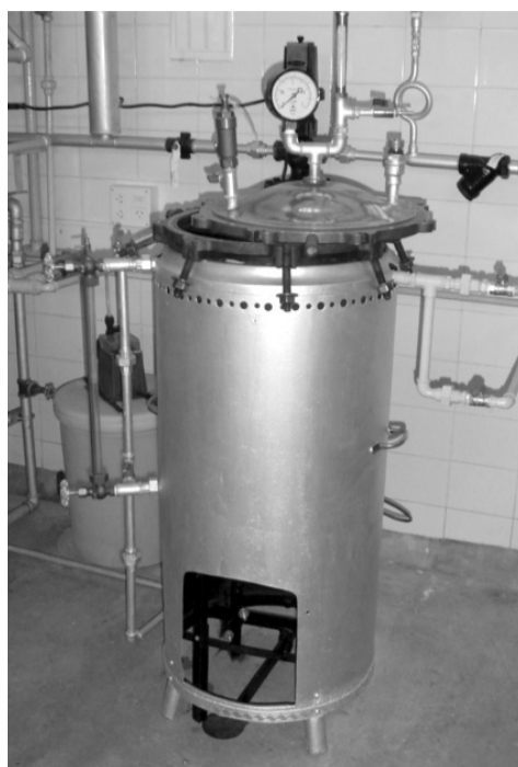
Modelo de autoclave para esterilización de conservas alimenticias en la planta piloto del Centro INTI-Mar del Plata
