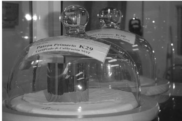
Patrón primario de masa conservado en INTI-Física y Metrología
