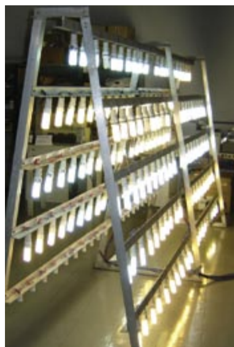
Banco de envejecimiento de lámparas en el Laboratorio de Luminotecnia del INTI
