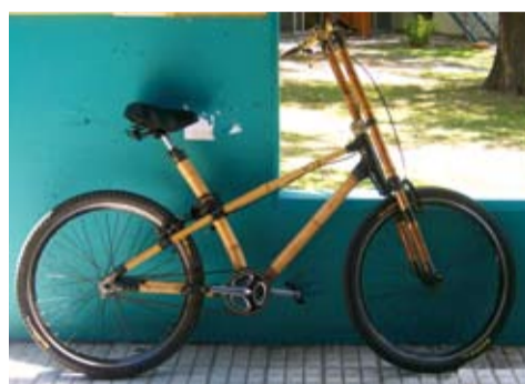
Foto 1: prototipo de bicicleta de bambú sometido a los ensayos.
