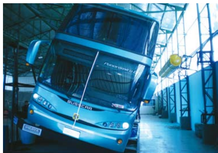
Para cumplir con el ensayo, el micro tiene que soportar ser inclinado a un ángulo de 28° para ambos laterales.
